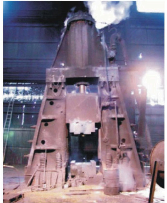
由于基础故障，锻锤向左前方倾斜
