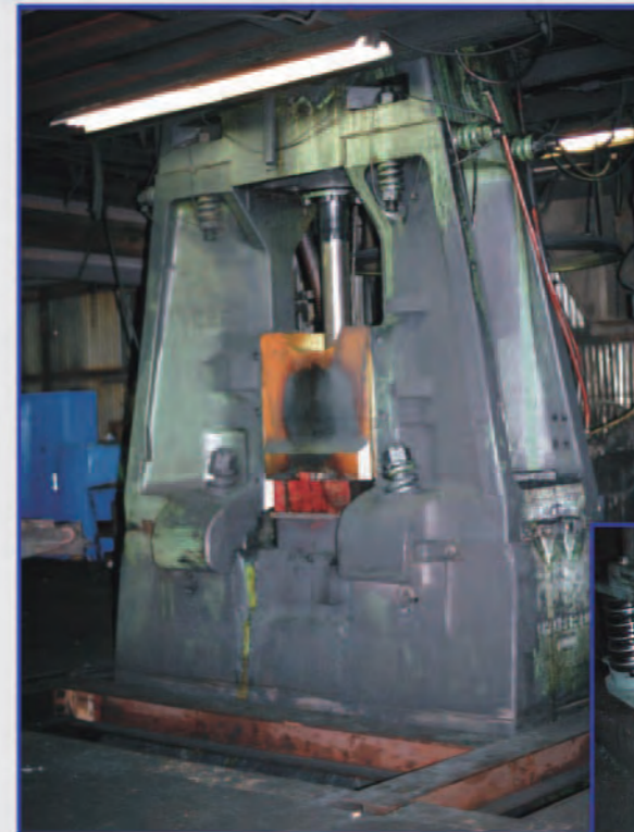
安装在FSV20-164-6S弹簧阻尼液隔振器上面的CECO #23锻锤
