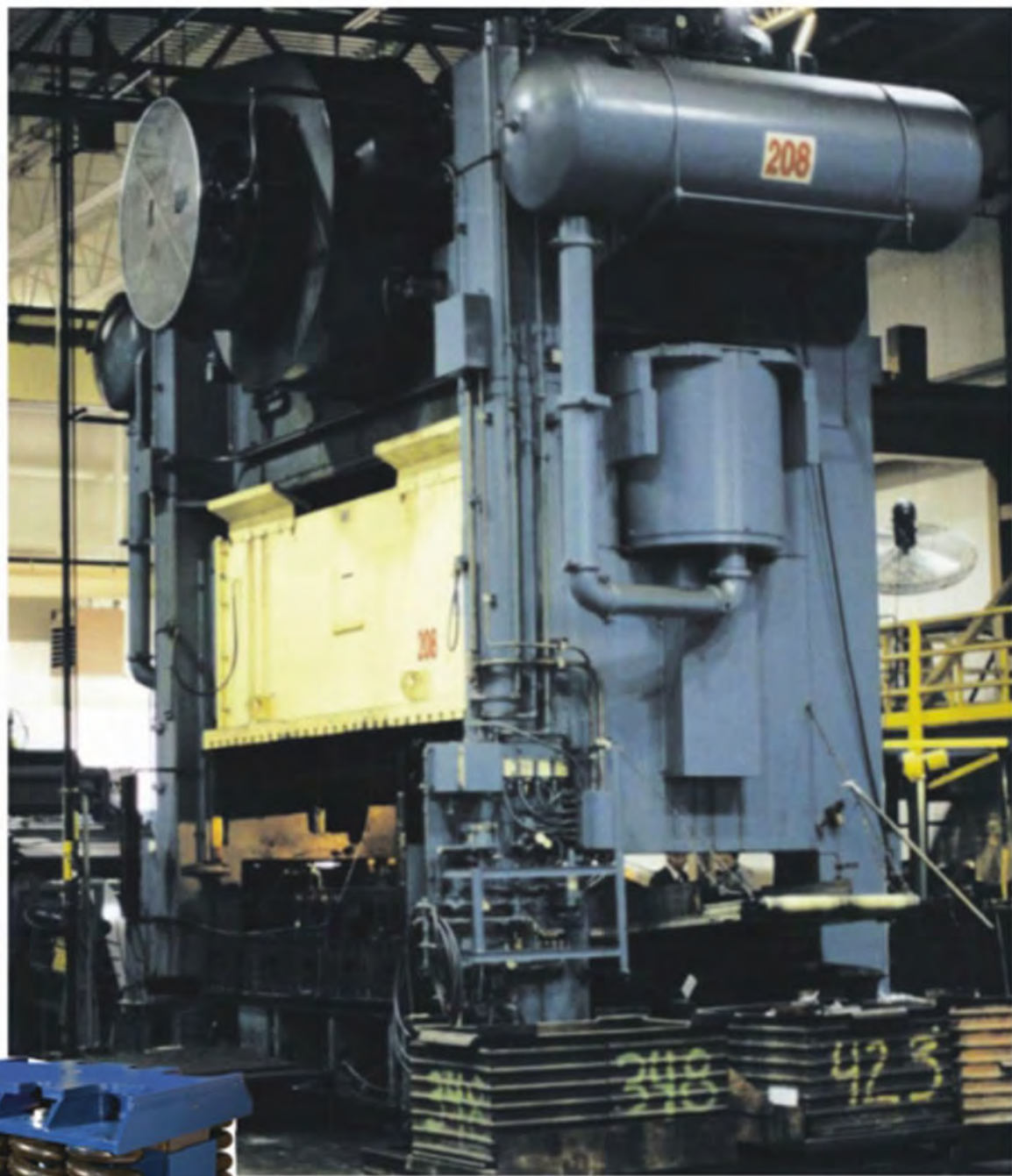
800吨冲压机在SVS Hy/Tuned™ 弹簧阻尼液隔振器上的安装
