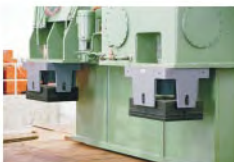
将隔振器与压力机的机脚连接。
